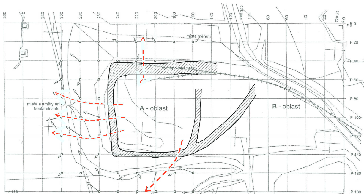
Obr. 3.10. Lokalizace míst prolínání vody hrázemi podle filtračních potenciálů (šikmou šedou šrafovou - stěny hráze, červené přerušované linie - místa prolínání hrázemi)
