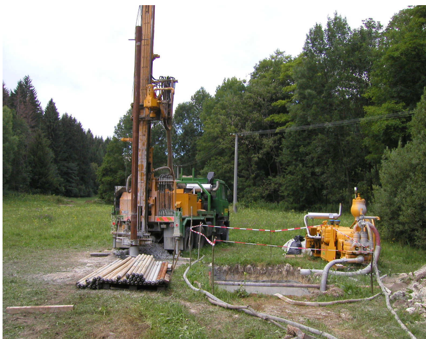
Obr.2.2. Mobilní vrtná souprava Wirth B1A
