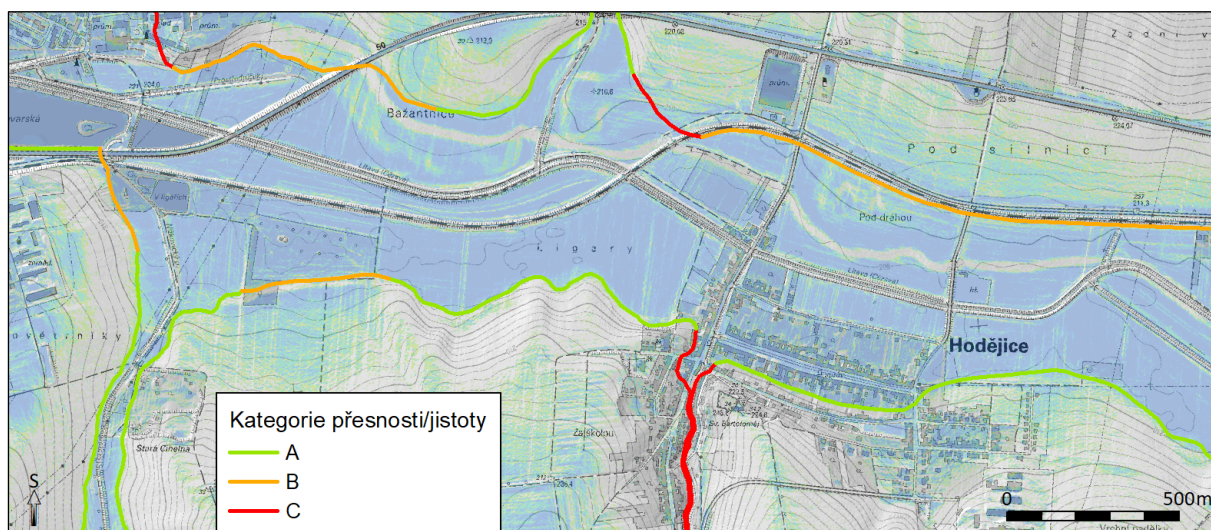
Obrázek 14: Kategorie přesnosti/jistoty v prvním zákresu hranice nivy na podkladu stínovaného modelu terénu, sklonitosti a topografické mapy.
