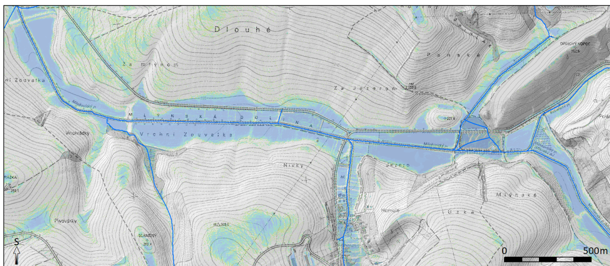
Obrázek 21: Typický příklad uzavřené nivy na podkladu stínovaného modelu terénu a sklonitosti, změna sklonu je dobře zřetelná a rychlá.
