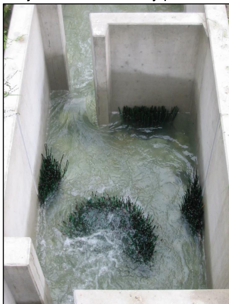
Obr. 4 Experimentální šterbinový rybí přechod obohacený kartáčovými prvky (foto Dr. Ing. R. Hassinger)
