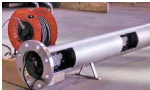
Obr. 11.5 Trubice se zábleskovými světly podle Fish Flow Innovation (Nizozemsko), publikováno se souhlasem
