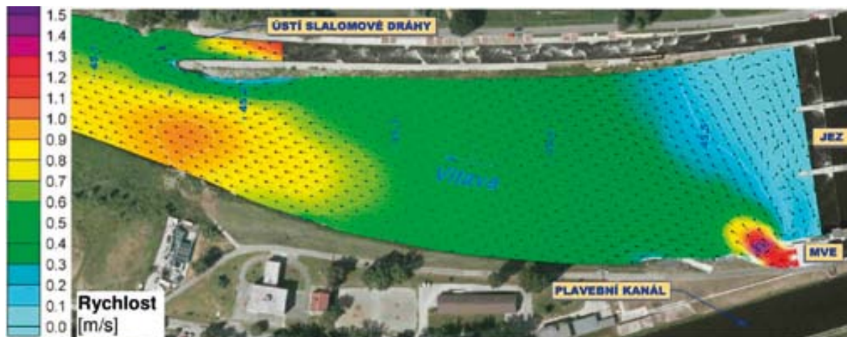
Obr. 10.43 Příklad rychlostního pole pod slalomovou dráhou na Vltavě v Troji při Q_{210d} = 87 \text{ m}^3/\text{s} z toho průtok slalomovou dráhou Q_{sl} = 14 \text{ m}^3/\text{s} .
