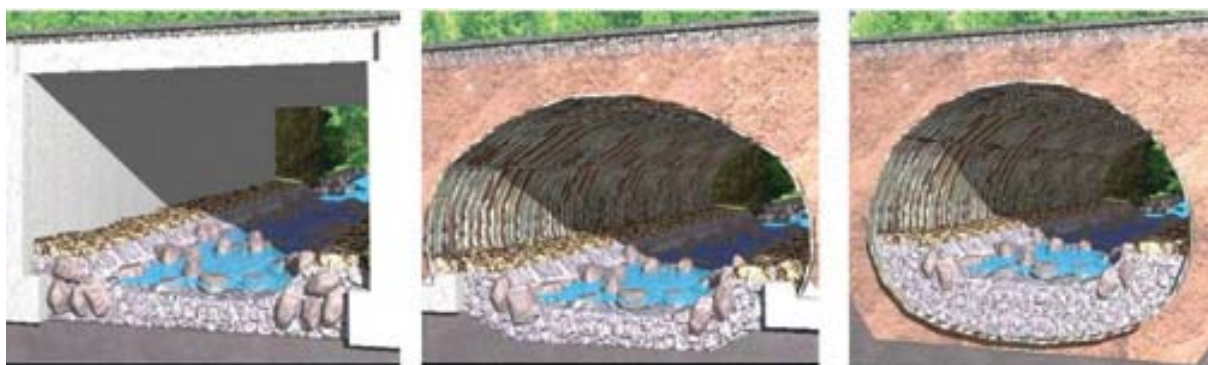
Obr. 10.40 Modely mostu a propustků s balvanitou úpravou dna
