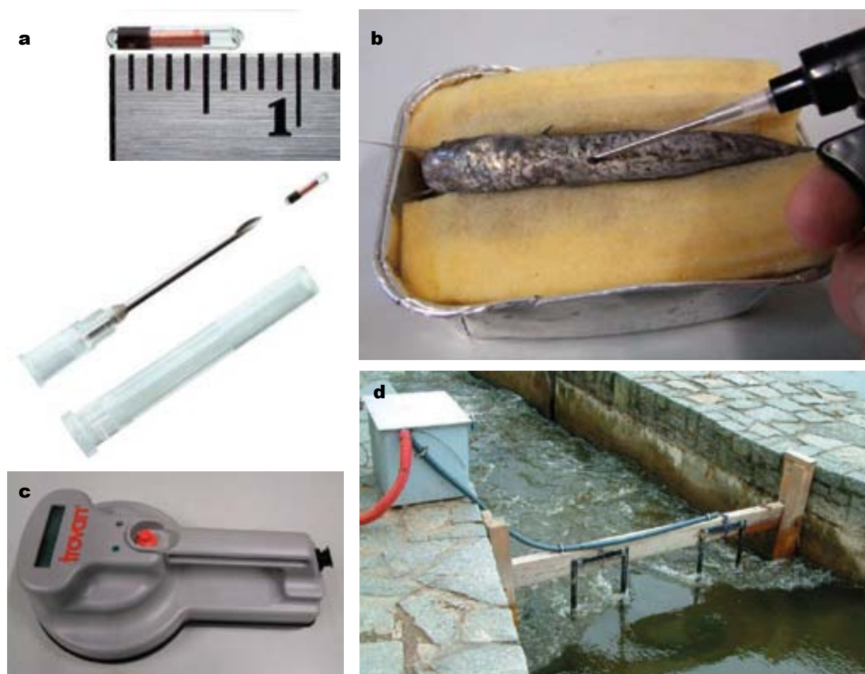
Obr. 12.6 Systém pasivních integrátorů – značka v injekční jehle (a), značení ryby (b), ruční čtečka (c) a detekční zařízení – anténa ve vodácké propusti na řece Sázavě (d).
