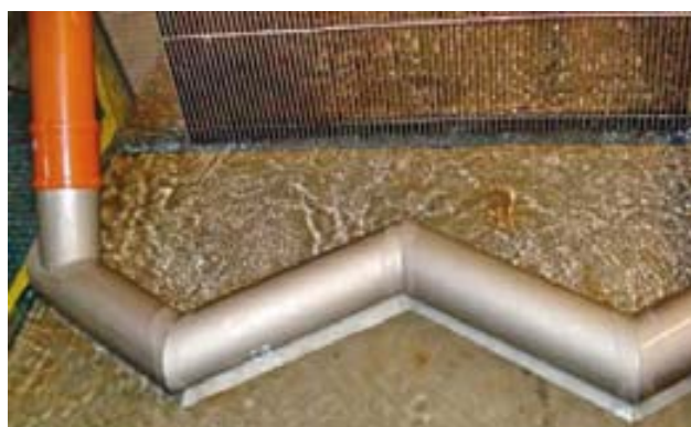
Obr. 11.7 Laboratorní testování perforovaného potrubí před česlemi pro úhoře na Univerzitě Kassel (Německo), publikováno se souhlasem
