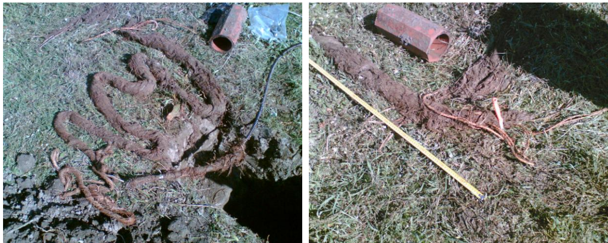
Obr.1 Příklad spontánního zarůstání drénů kořeny dřevin v situačně náchylných polohách (u drenážní šachty, u drenážní výusti, při podcházení drénu pod linií dřevin apod.). Okres Chrudim Foto: P. Pražák
