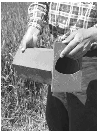
Obr.3 Příklad provedení clony a způsob instalace vzhledem k drenážce Foto: M. Soukup
