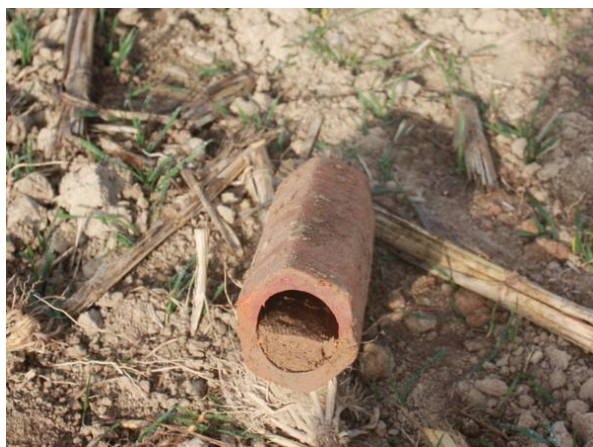
Obr.2 Příklady částečného nebo úplného zanesení drénů zemíými částicemi. U částečného zanesení drenážní prvek nadále plní odvodňovací a transportní funkci v závislosti na rozsahu zmenšení světlosti drenážního potrubí. Jiné důsledky zanesení jsou u drénů sběrných a jiné u drénů svodných, do kterých přitéká drenážní voda z výše ležících, plošně rozsáhlejších, částí systému. Foto: Z.Kulhavý, M.Čmelík
