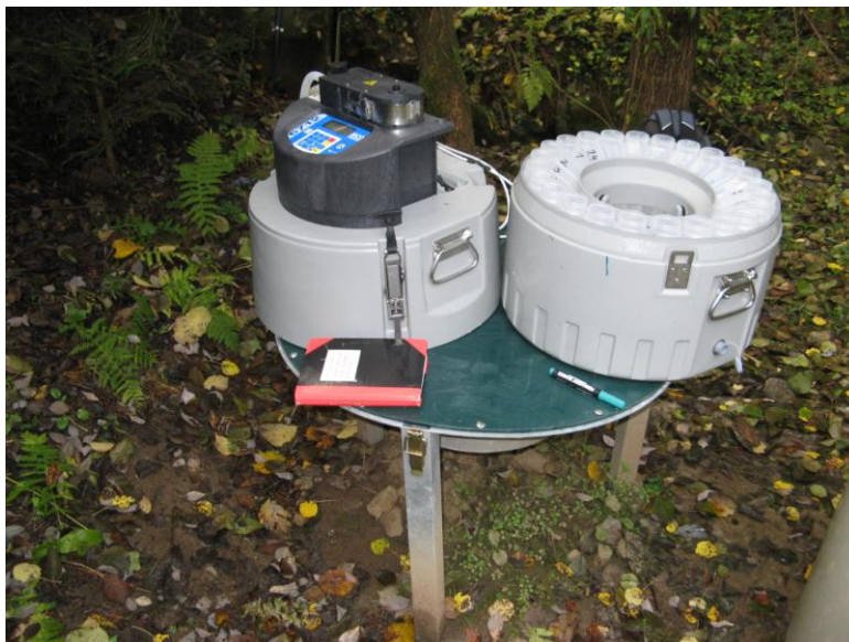
Obr.3-4 Automatický vzorkovač vod ISCO 6712. Autor: P.Fučík
