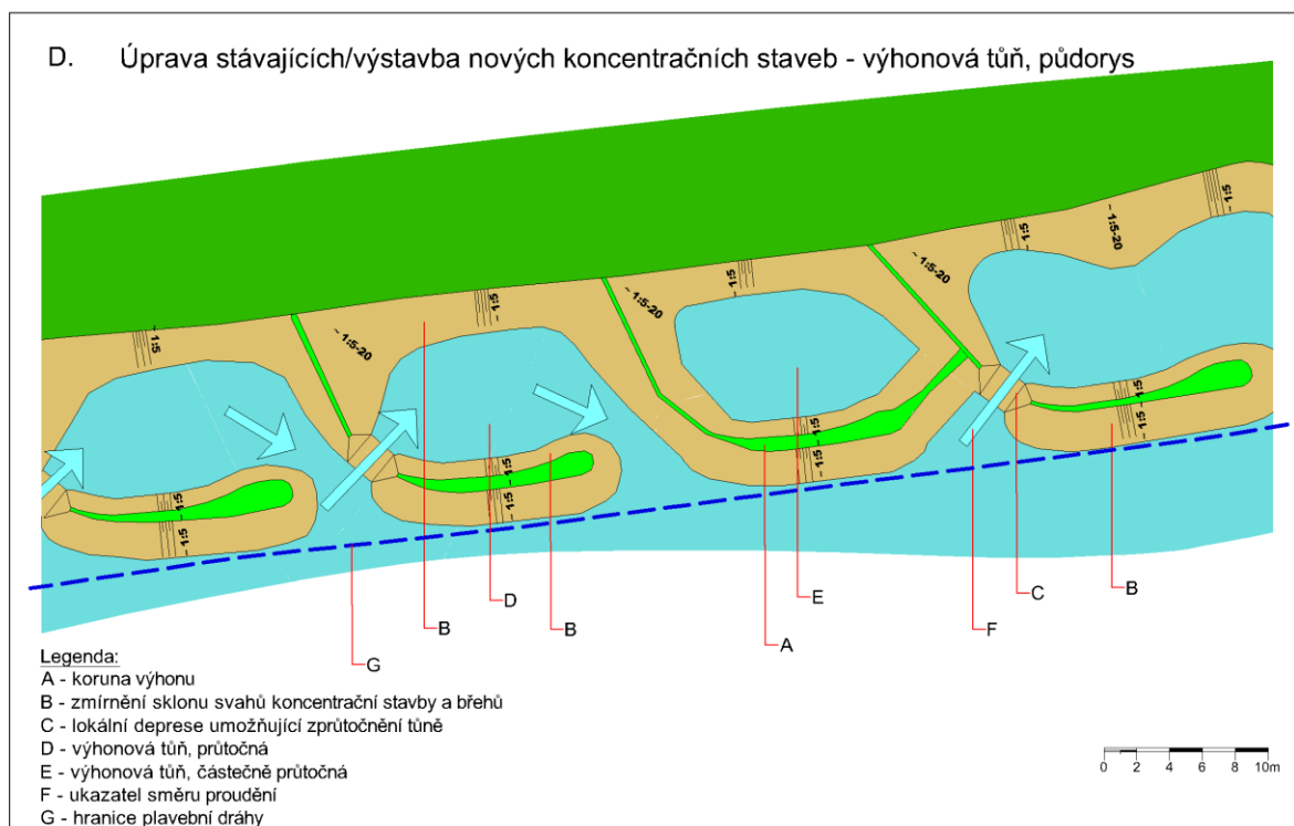
Obr. 11 Obecné opatření D - Výhon, výhonová tůň, situační schéma
