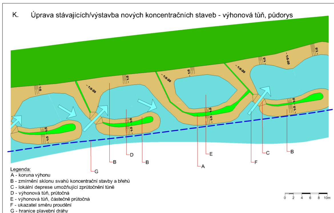
Obr. 34 Obecné opatření K - výhonová tůň, situační schéma
