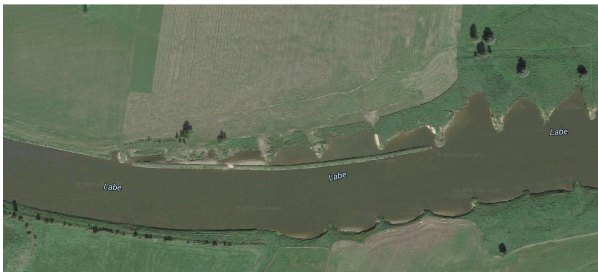
Obr. 49 Strukturovaná koncentrační hráz a výhonové pole uložené na pravém břehu Labe ř. km cca 283,85 – 204,40 (Spolková republika Německo)
