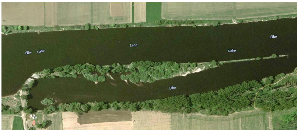
Obr. 56 Průleh v koncentrační hrázi. Labe Černěves (okr. Litoměřice)
