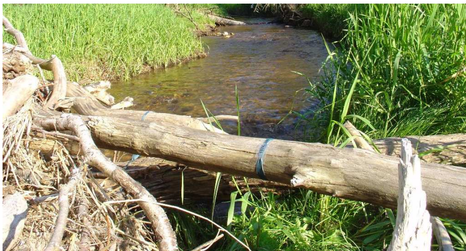
Obr. 2.1.3 Kusy naplaveného dřeva označené páskou a štítkem s číslem na lokalitě řeky Blanice na Šumavě slouží k výzkumu dynamiky dřevní hmoty při povodňových průtocích.
