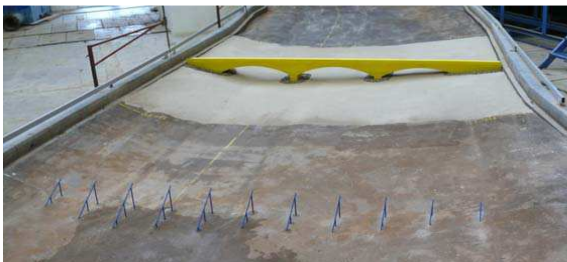
Obr. 4.3.4: Sada ochranných bárek a jejich rozmístění na hydraulickém modelu v laboratorní hale VÚV TGM, v.v.i. v rámci výzkumu pro projekt financovaný z prostředků SFDI.
