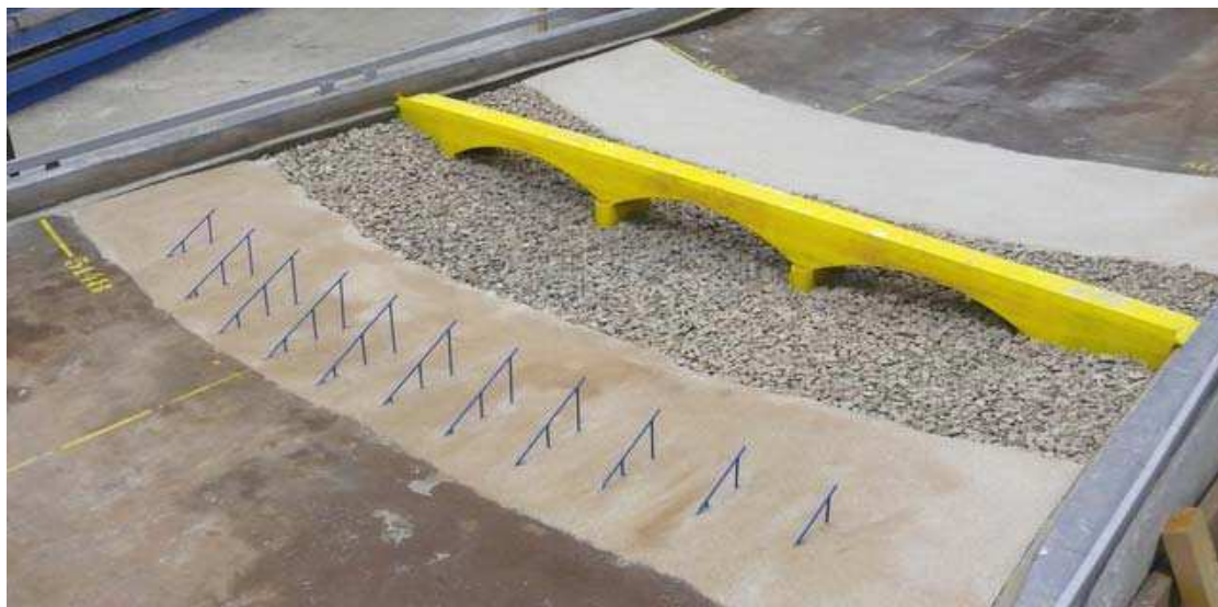
Obr. 4.3.3: Sada ochranných bárek a jejich rozmístění na hydraulickém modelu v laboratorní hale VÚV TGM, v.v.i. v rámci výzkumu pro projekt financovaný z prostředků SFDI.
