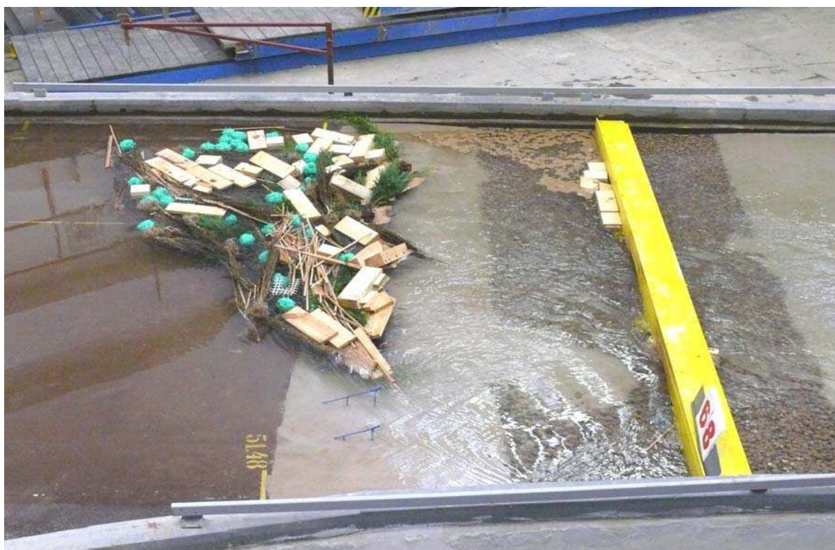
Obr. 4.3.6: Výsledný efekt aplikace sady ochranných bárek při ochraně mostního objektu proti plávi při povodňové události (Balvín a kol., 2009).
