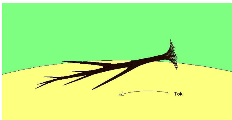
Obr. 5.2.1.3 Dřevní hmota uložená tak, aby kořenový systém s balem ležel na břehu a bránil odplavení. Odolnost proti odnosu je možné zvýšit kotvicími prvky popsány výše.
