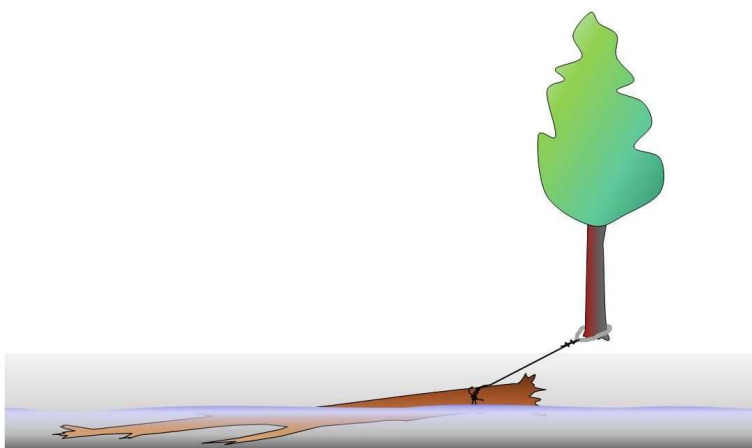
Obr. 5.1.2 Kotvení dřevní hmoty lany ke stromu na břehu.
