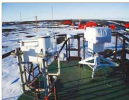
▲ Instalovaný Brewerův spektrofotometr na argentinské stanici Marambio. Data z měření stavu ozonu se zpracovávají na ČHMÚ v Hradci Králové.
