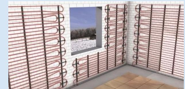
Obrázek 33 Chlazení i topení integrované do konstrukce. Zdroj: <https://www.topin.cz/clanky/system-plosneho-vytapeni-a-chlazeni-s-moderni-regulaci-prinasi-usporu-energie-detail-14427>
